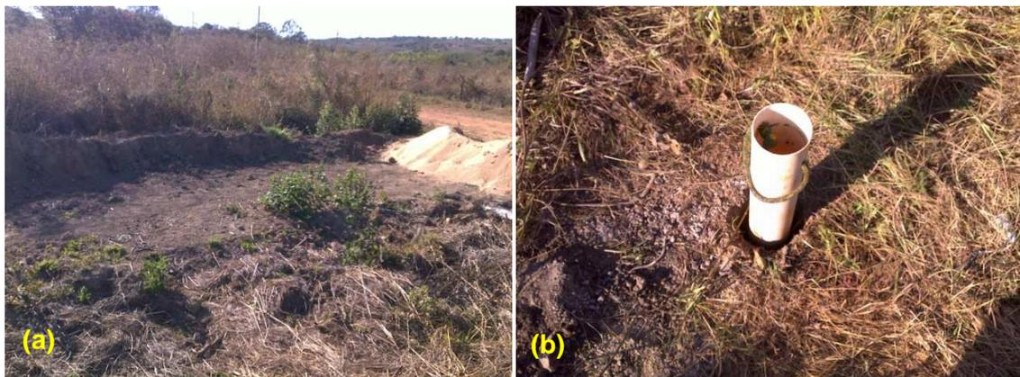
Figura 42: (a) Situação do local de realização do ensaio na região dissecada de vales. (b) Vista do local de realização do ensaio (método Open end Hole). (Coordenadas: 203637E/ 8225305N, Projeção: UTM, Datum SIRGAS 2000, Zona 23S). Data: 11/08/2012. Foto tirada por Gabriel Franco Miranda.
