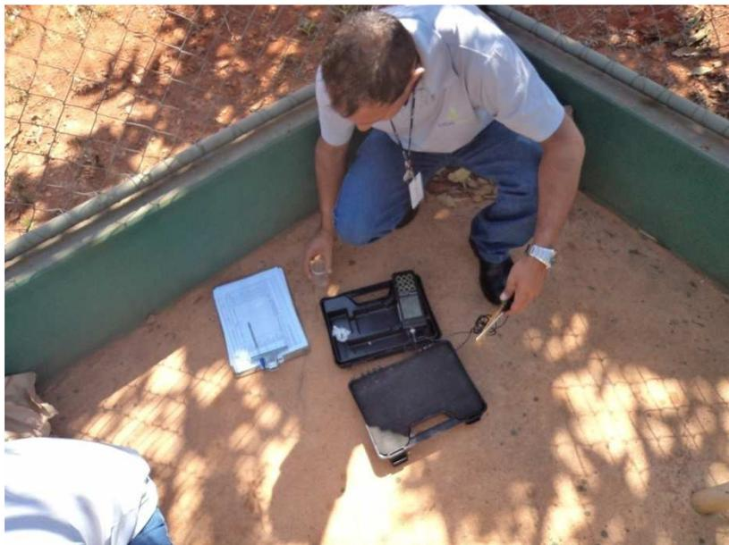
*Figura 55: Medição do pH no local de coleta do poço 01 utilizando o peagômetro*
